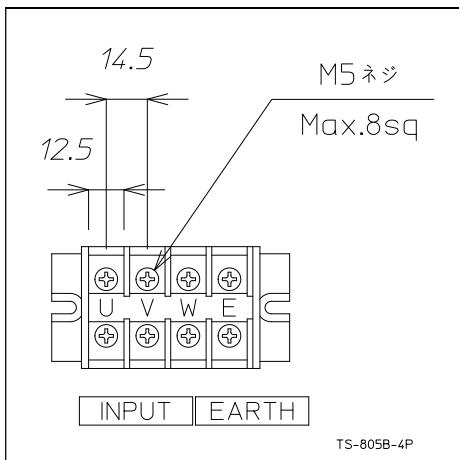
※入力電源の接地相をV相に接続して下さい。
