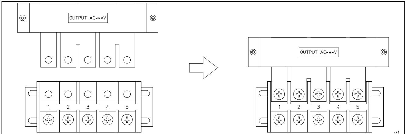
端子台に出力電圧表示板の取り付けが出来ましたら、化粧パネルを必ず取り付けて下さい。
