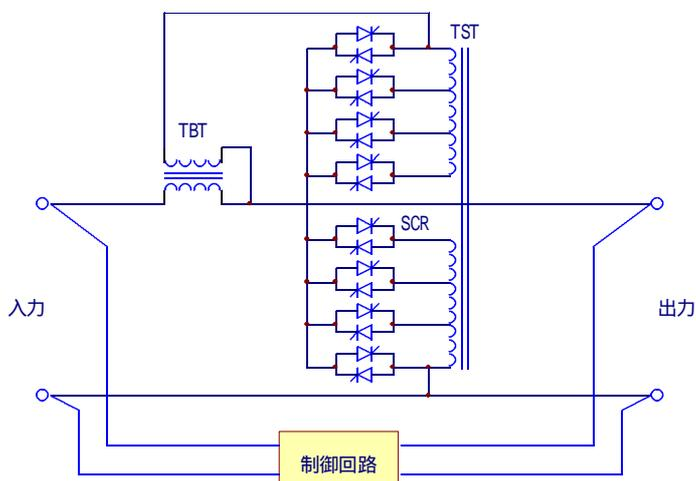
主変圧器(TST)は粗タップと密タップの2巻線より構成されています。この主変圧器(TST)の粗タップと密タップの組み合わせにより直列変圧器(TBT)に加える電圧を制御して出力電圧を一定に保つ様に働きます。今、仮に出力電圧が定格値より低下した場合、制御回路部にて出力電圧の変化を検出します。この変化をデジタル信号に変換して電子スイッチ部(SCR)へ送ります。主変圧器(TST)に接続している電子スイッチ(SCR)が順次切り変り、出力電圧が定格値になるようにします。また、出力電圧が上昇した場合にも同様の動作をします。
