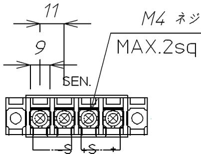
外部センシング する際は、1-2,3-4の短絡線を外し、2,3から負荷端子へ接続して下さい。
