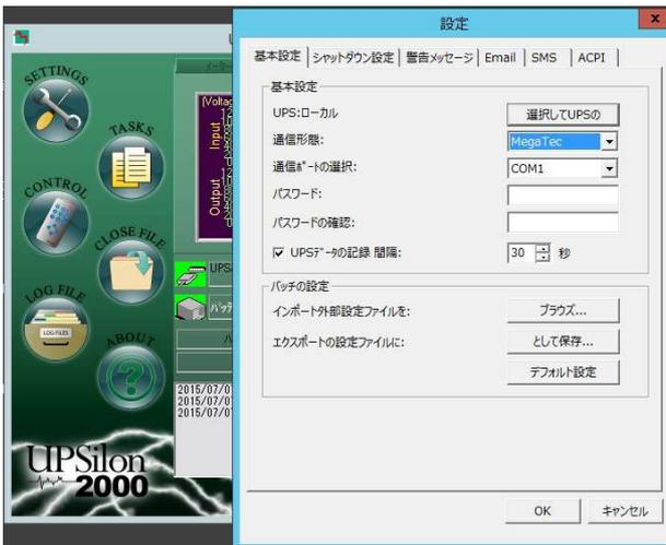
「基本設定」「警報メッセージ情報の編集」「シャットダウン時の動作」「自動シャットダウンの設定」が設定出来ます。
