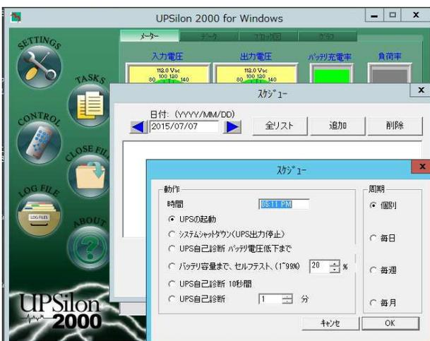
「システムシャットダウン」「再起動」「バッテリー診断」等の動作をスケジュール設定可能です。
