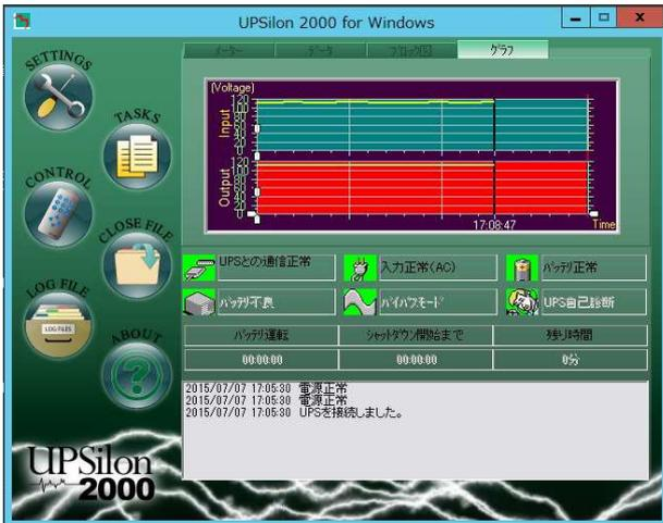
入力電圧と出力電圧の動きがグラフで表示されます。
