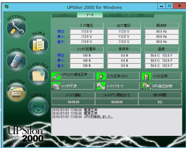
入力電圧、出力電圧、周波数、バッテリー充電率、負荷率、温度の現在値及び最小、最大値を表示します。
