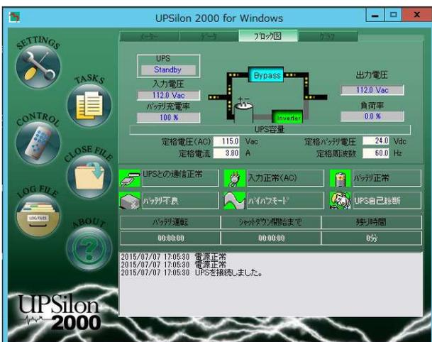
現在の給電状態をブロック図で表示します。
