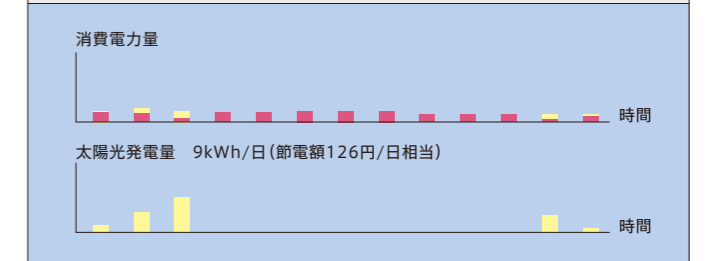
fig2: 外部電力計測により休日の太陽光発電量を最大化
